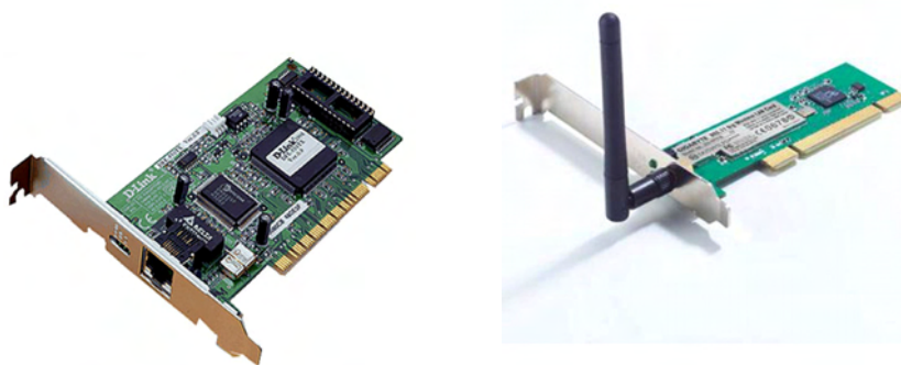
Σχήμα 1.17 Κάρτα δικτύου. [Αριστερά: ενσύρματη, Δεξιά: ασύρματη]
