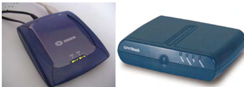
Σχήμα 2.10 [Αριστερά: Modem DSL , Δεξιά: Modem-Router DSL]
