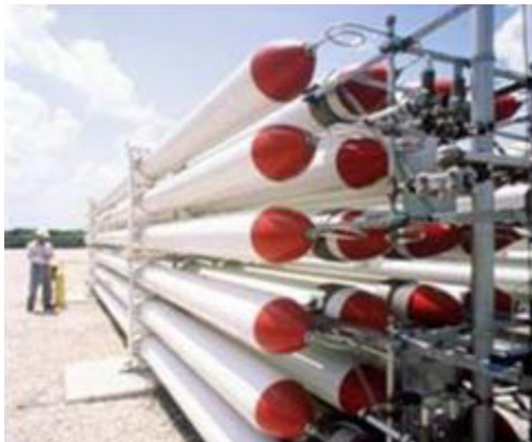
Εικόνα 16: Μεταφορά υδρογόνου σε σωλήνες υψηλής πίεσης (πηγή: U.S. Department of Energy Hydrogen Program ).
