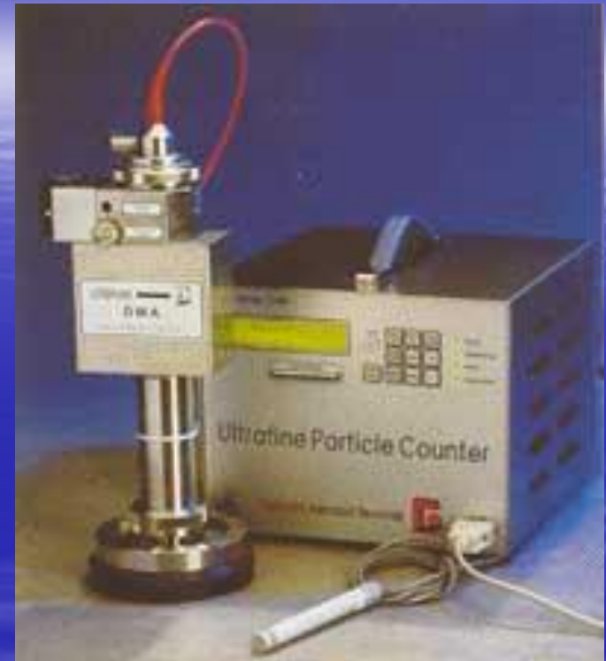
Εικόνα 28 Το όργανο μέτρησης του πλήθους των ατμοσφαιρικών αιωρούμενων σωματιδίων που χρησιμοποιήθηκε στην παρούσα εργασία (CPC – DMA, SMPS, GRIMM).
