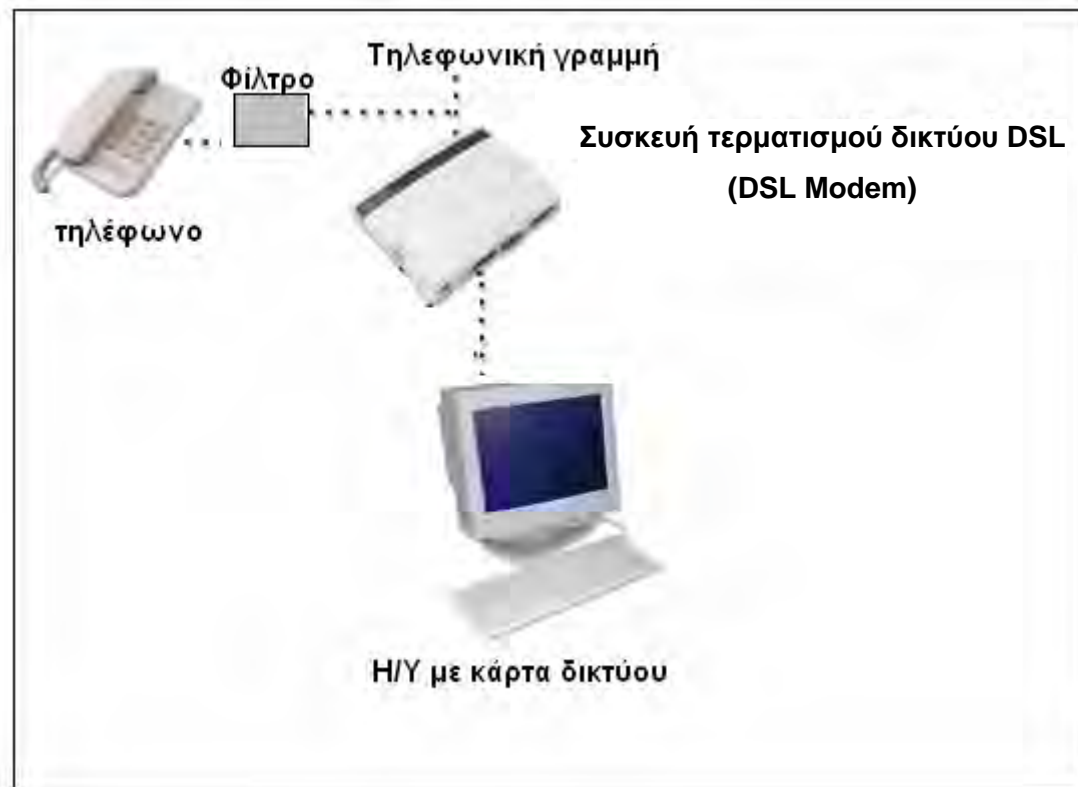
Σχήμα 3.4 Παράδειγμα υλοποίησης σύνδεσης DSL
