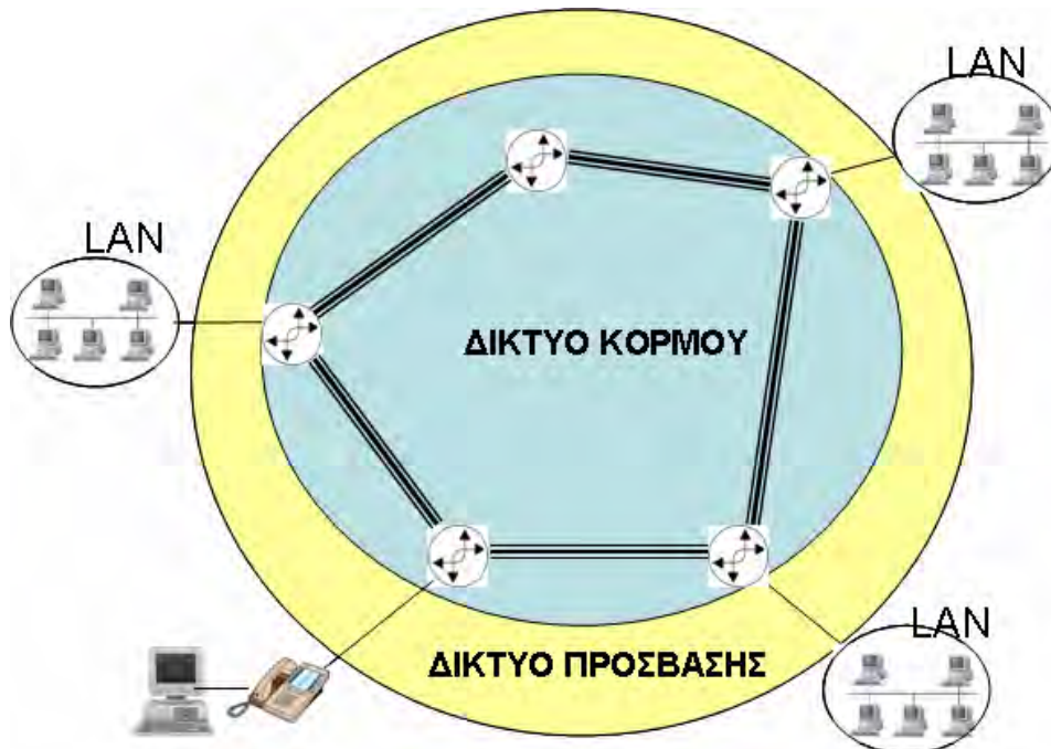
Σχήμα 1.13 Σχηματική αναπαράσταση δικτύου πρόσβασης και δικτύου κορμού
