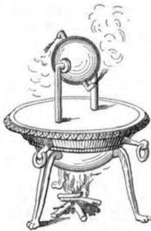
Η αιολόσφαιρα του Ήρωνα. Η πρώτη ατμομηχανή στην Ιστορία
