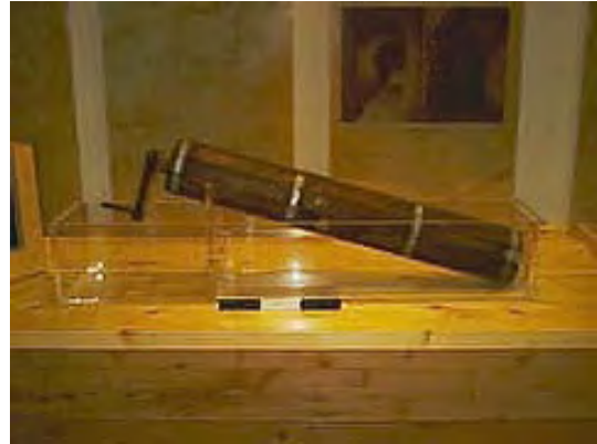
Κοχλίας του Αρχιμήδους. Ομοίωμα μηχανισμού άντλησης ύδατος. Αποτελείται από ξύλινη κυλινδρική θήκη-αγωγό, μέσα στον οποίο περιστρέφεται ελικοειδής κατασκευή. Χρησίμευε στην άρδευση αγρών, καθώς και στην άντληση υδάτων από το εσωτερικό των πλοίων. Τεχνικό Μουσείο Θεσσαλονίκης
