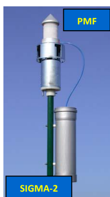
Σχήμα 5-3 Διάταξη παθητικού δειγματολήπτη με το φίλτρο συγκέντρωσης μάζας γύρης
