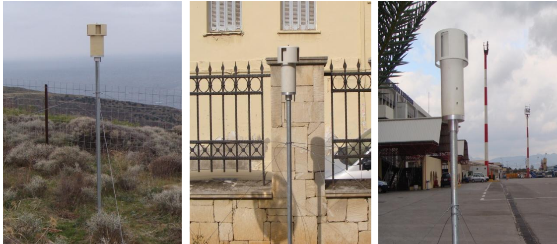
Σχήμα 5-2 Οι παθητικοί δειγματολήπτες Sigma-2 τοποθετημένοι στην περιοχή της Φινοκαλιάς (σταθμός 1-αριστερά), στο κέντρο του Ηρακλείου (σταθμός 2-κέντρο) και στο αεροδρόμιο Ν.Καζαντζάκης του Ηρακλείου (σταθμός 3-αριστερά)
