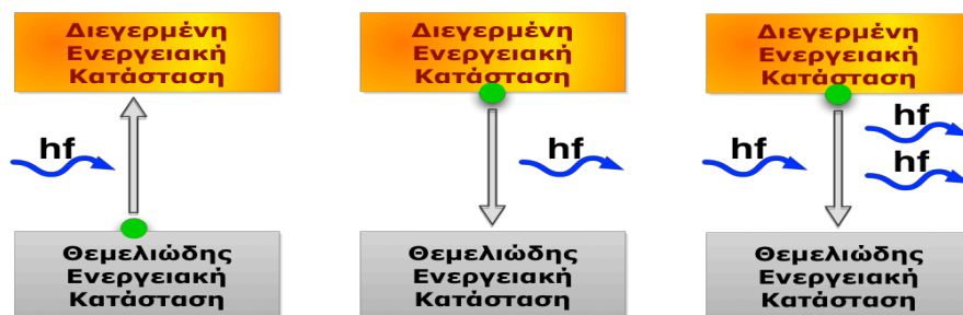
Σχήμα 5-1: Απεικόνιση της ατομικής απορρόφησης (α), της αυθόρμητης εκπομπής (β) και της εξαναγκασμένης εκπομπής (γ).
