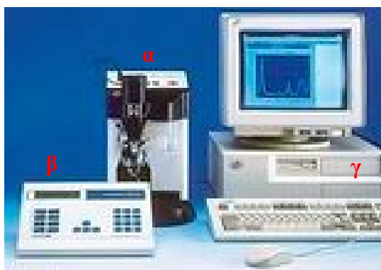
Εικόνα 1.19. Οργανολογία παλμικής πολαρογραφίας α) Η μονάδα περιλαμβάνει το σύστημα ηλεκτρονικού υπολογιστή και το πολαρογραφικό στοιχείο, β) ο αναλύτης μπορεί να χρησιμοποιηθεί στην κλασσική ή παλμική πολαρογραφία, γ) τα αποτελέσματα καταγράφονται σε καταγραφέα χ-ψ.
