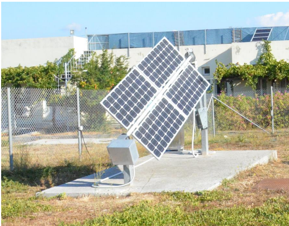
Εικ. 3: Τροποποιημένος πολικός ιχνηλάτης του Εργαστηρίου Ενεργειακών και Φωτοβολταϊκών Συστημάτων (LEPS)
