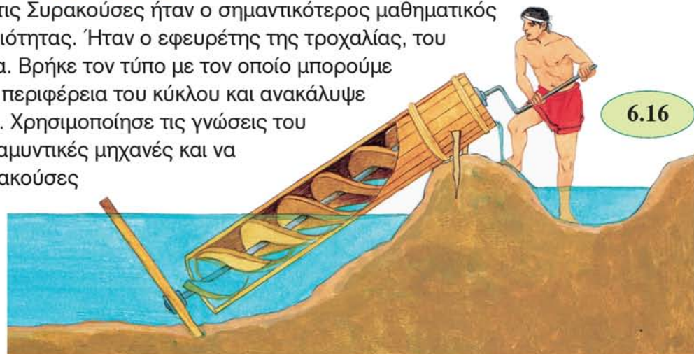
Αναπαράσταση του κοχλία του Αρχιμήδη, με την οποία μπορούσε κάποιος να αντλήσει νερό από ένα χαμηλό σημείο.
