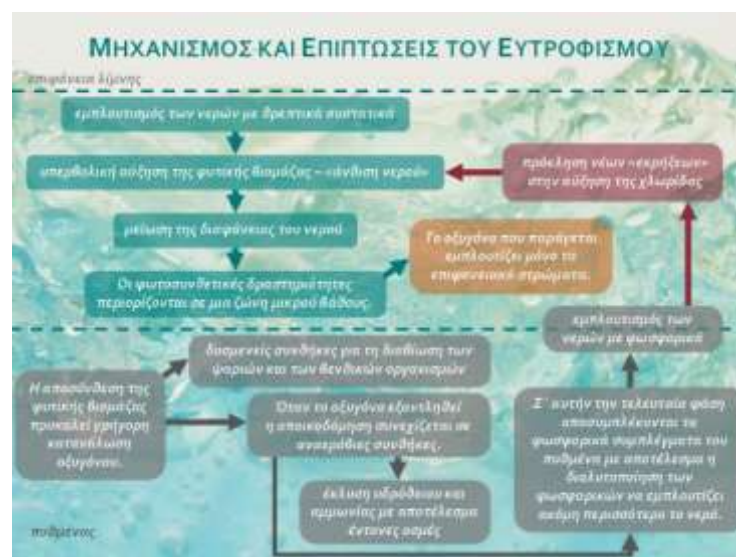
Σχήμα 1. Μηχανισμός και επιπτώσεις του ευτροφισμού σε μια λίμνη
